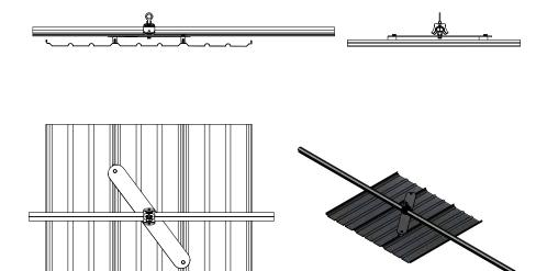
SecuRail Pro sur toiture joints debout
