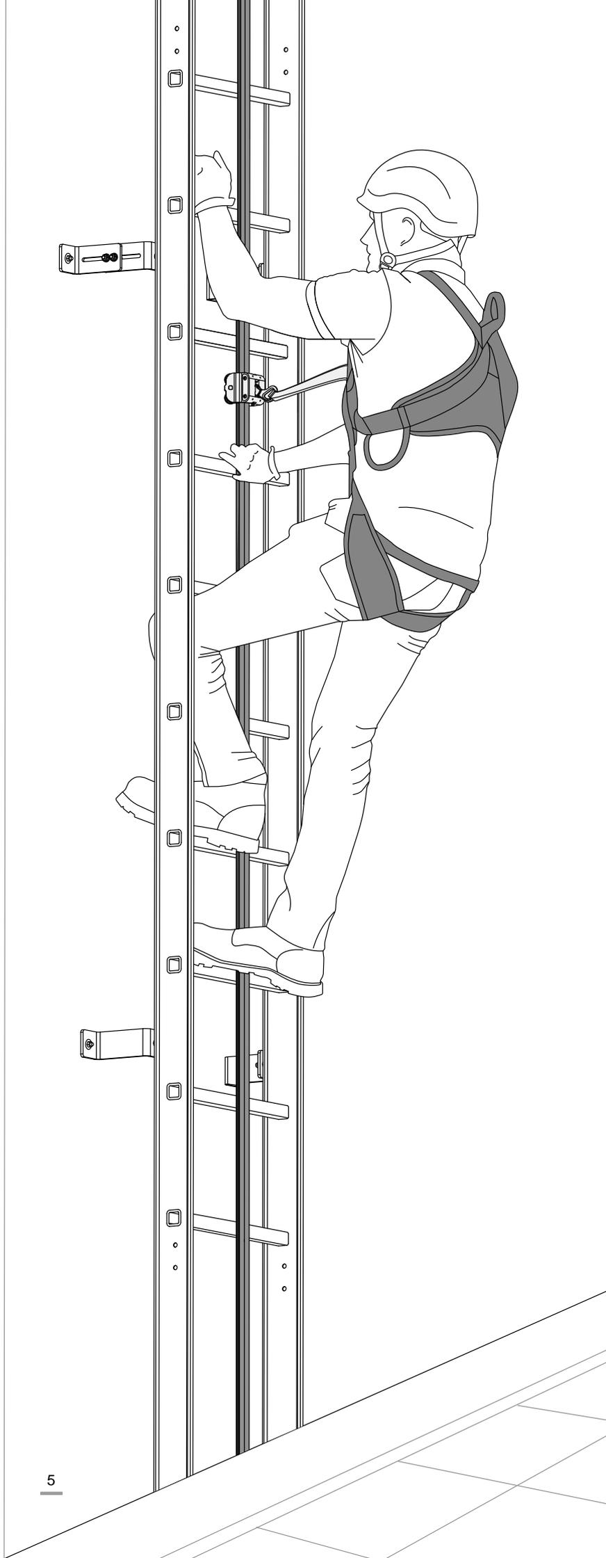
Die SecuRail Pro Vertical ist eine starre Absturzsicherung, die den Zugang zu jeder Struktur sichert. Wenn sie an eine bestehende Leiter geklemmt wird, sichert sie den Endbenutzer viel besser als die üblichen Sicherheitsbügel. Der Vorteil des Schienensystems ist, dass der Sturz sofort gestoppt wird, ohne dass es zu einer dauerhaften Verformung der Schiene kommt. Alle Kräfte werden im Bereich des Sturzes aufgebracht.
