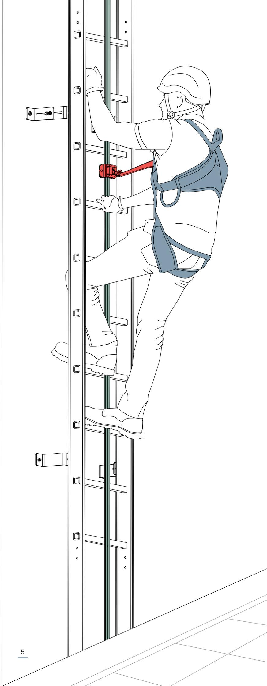
Die SecuRail Pro Vertical ist eine starre Absturzsicherung, die den Zugang zu jeder Struktur sichert. Wenn sie an eine bestehende Leiter geklemmt wird, sichert sie den Endbenutzer viel besser als die üblichen Rückenkorbe. Der Vorteil des Schienensystems ist, dass der Sturz sofort gestoppt wird, ohne dass es zu einer dauerhaften Verformung der Schiene kommt. Alle Kräfte werden im Bereich des Sturzes aufgebracht.
