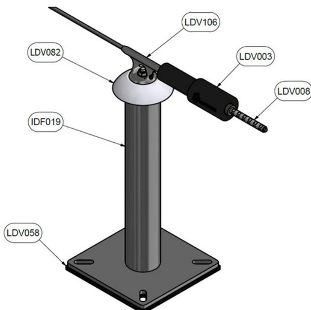
Ancre terminale équipée d'un absorbeur d'énergie sur potelet
