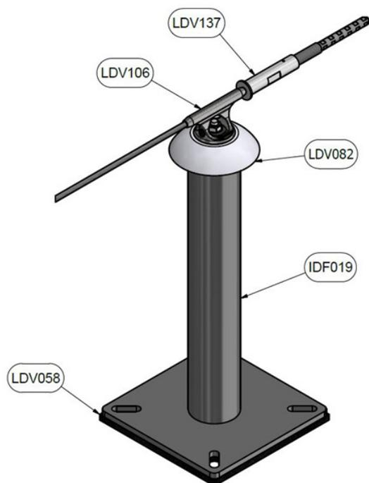
Ancre terminale équipée d'un tendeur de ligne sur potelet
